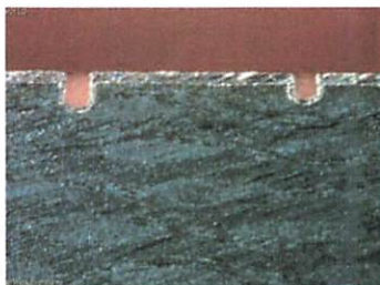
gefüllt und geschliffen, Bohrung 0,2 mm
